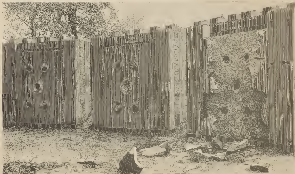
Plancha de acero Plancha de acero níquelado Plancha Compound Ensayos comparativos de diferentes planchas en el polígono de Annápolis (Estados Unidos). - Estado de las planchas después del quinto disparo
